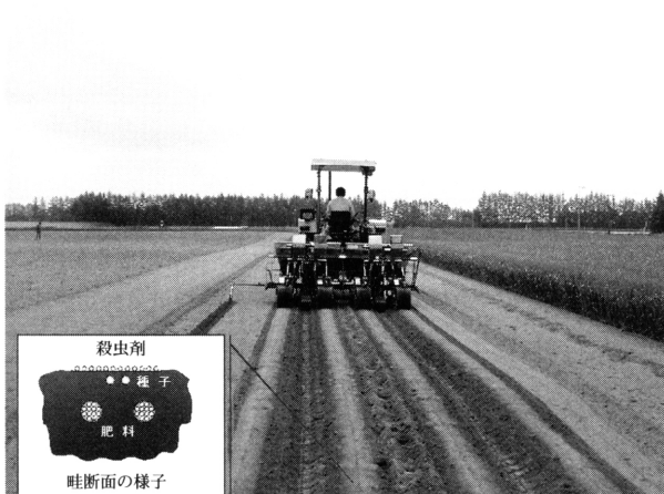
図1. 施肥播種機によるキャベツの直播の様子と畦断面の様式図（2001年6月7日）
